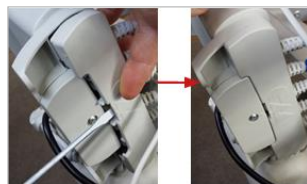
Nasadit kryt konektorů - zasuňte kryt konektorů na správné místo
