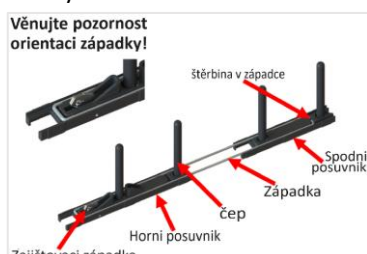
Posuvný systém bez distančního bloku (používá se s madly o výšce 110,5 mm a kovovými madly MED)
