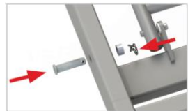
Montáž čepu pojistného kolíku 'R' a plastové pouzdra
